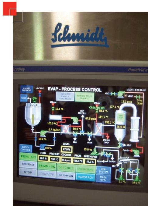
Die höheren Temperaturen helfen, die Zuckerlösung fließfähig zu halten, während das Wasser entfernt wird. Sobald die Lösung die richtige Konzentration bzw. den niedrigen Wassergehalt erreicht hat, wird sie abgekühlt und zu runden Bonbonformen geformt, bevor sie verpackt wird.
