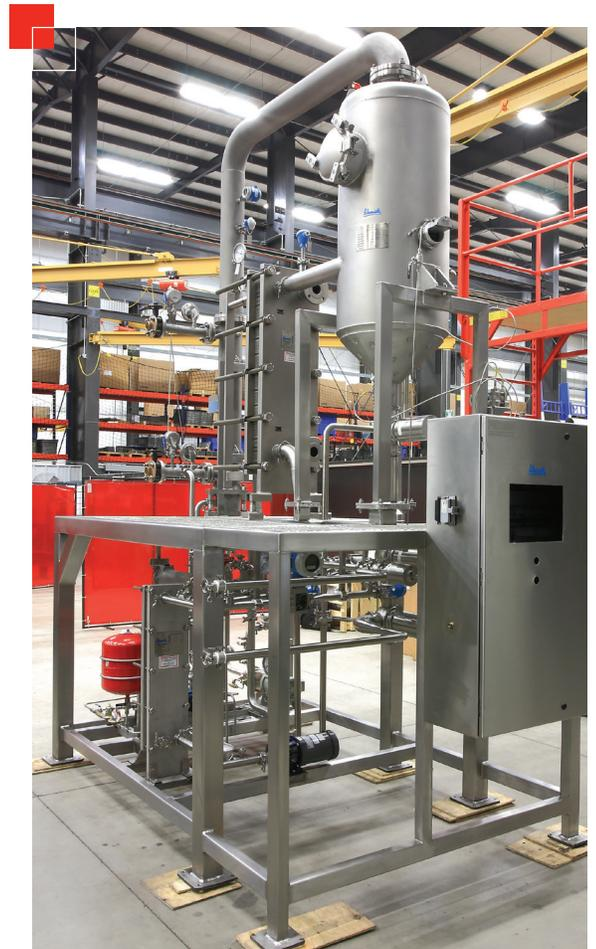
Dare Foods beauftragte API mit der Entwicklung eines Plattenwärmeübertragungssystems zur Entfernung von Wasser aus einer **70%-igen** Feststofflösung, um eine **98,5%-ige** Feststofflösung zu erreichen, wobei nur **1,5%** oder weniger Wasser übrig bleiben.
