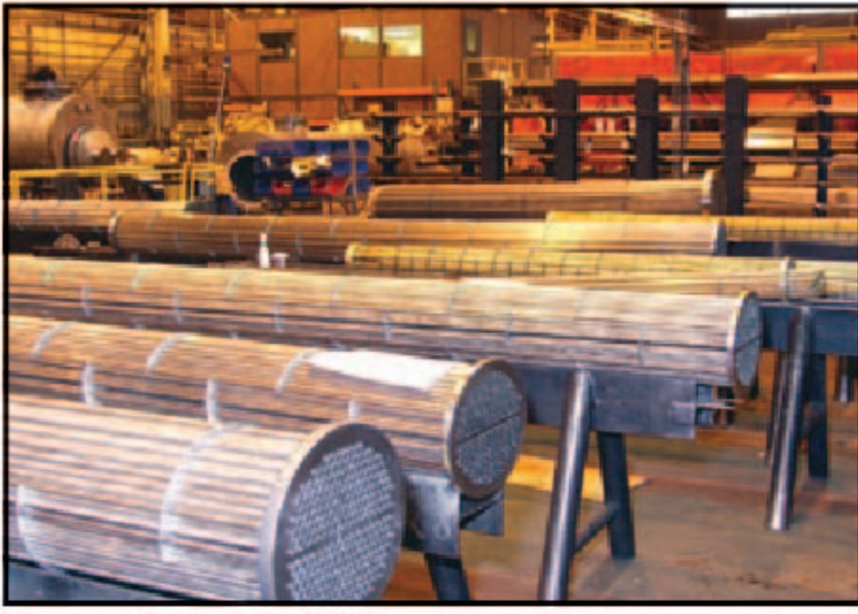
艾普尔 Basco 车间 管束组装区域
