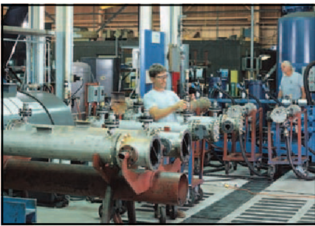
艾普尔 Basco 车间 OP 系列换热器组装区域
